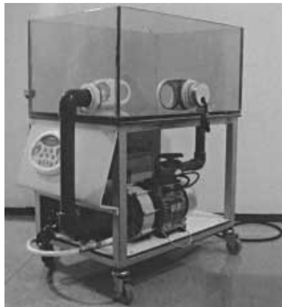
Fig. 4. — Vasca termostata appositamente costruita da Teuco-Guzzini Group SpA, per mantenere costante per almeno 30' la temperatura dei fantocci immersi in acqua durante i test di durata delle microbolle alle diverse temperature.
