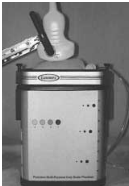
Fig. 3. — Fantoccio Gammex RMI 403 GS insonato interponendo al di sotto della sonda un palloncino in latex contenente 250 ml di soluzione fisiologica pura oppure addizionata di SonoVue® a varie concentrazioni. La distanza tra sonda e reperi contenuti nel fantoccio Gammex è stata mantenuta rigorosamente costante durante tutti i test fissando il trasduttore con un'apposita pinza.
