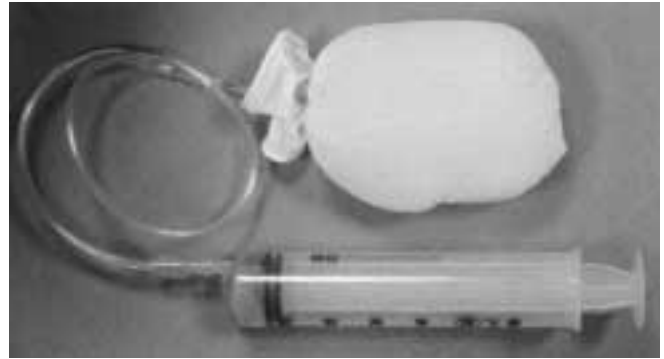
Fig. 1. — Palloncino in latex utilizzato come fantoccio per l'esecuzione dei test. Il palloncino è connesso ad un tubo dotato di raccordo per siringhe o deflussori per soluzione salina.
